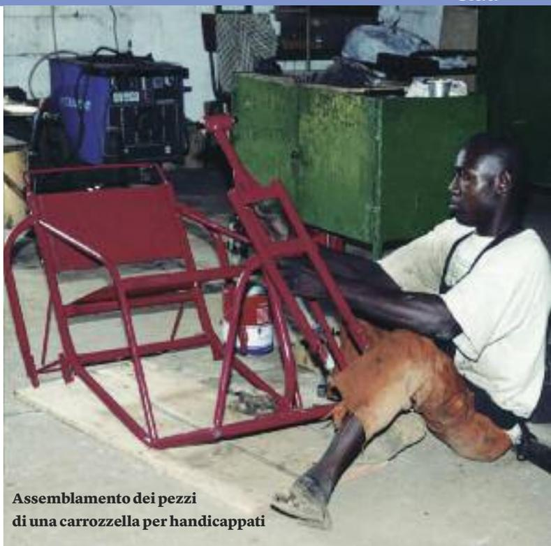
**Assemblamento dei pezzi di una carrozzella per handicappati**
